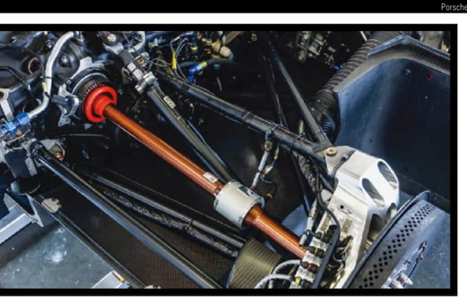
写真左上から右下にかけて写っているのがポルシェ963のドライブシャフト（茶色）。その中央からややアップライト寄り（右下側）に見えるのがトルクセンサー。ここで、ドライブシャフトが受け止めた回転力を検出している。
